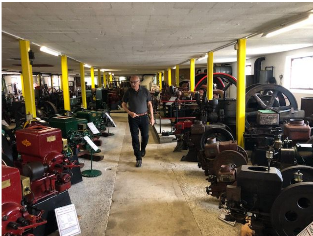
Motorer, motorer.... De fleste motorer er totalrenoveret og står som da de var nye. Udstødninger er samlet i rør over loftet og er derfor startklare.
