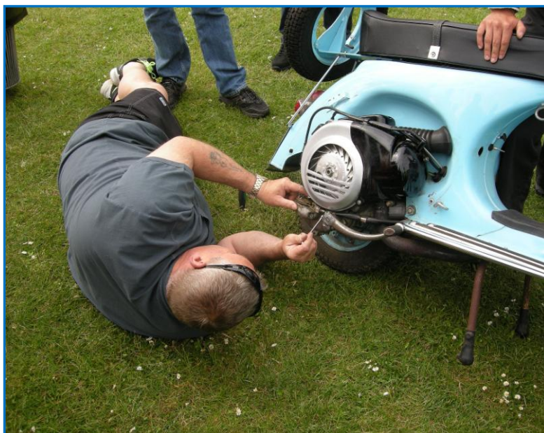
Justering af gearkablerne kan være nødvendigt
