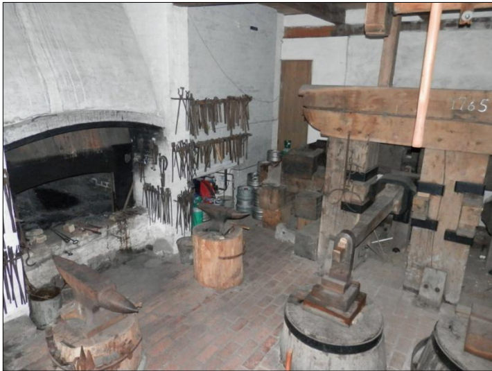
Esse og ambolte, tænger og vandspande til hærkning af stålet
