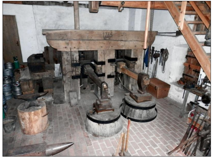
2 Hamre der bevæges af vandkraften via akslen på skovlhjulet
