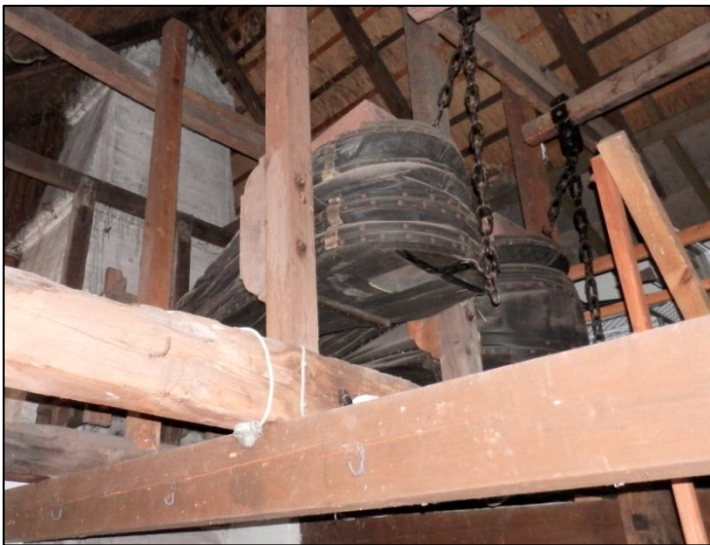
Blæsebælgene drives af vandkraften fra de ene skovlhjul
