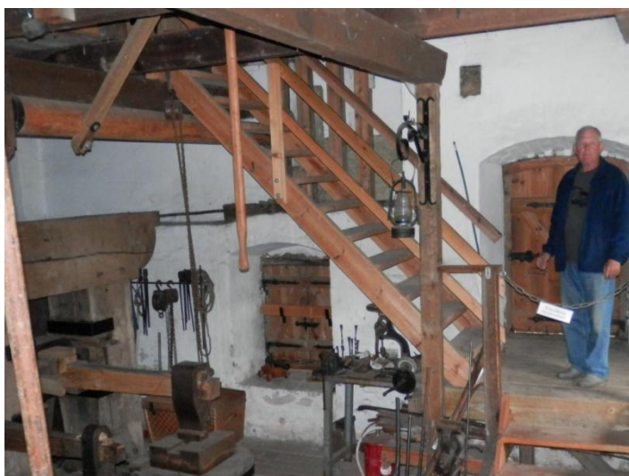
Trappen fører op til 2 store blæsebælg der forsyner Essen med ekstra ilt for at opnå tilstrækkelig varme til smedningen.
