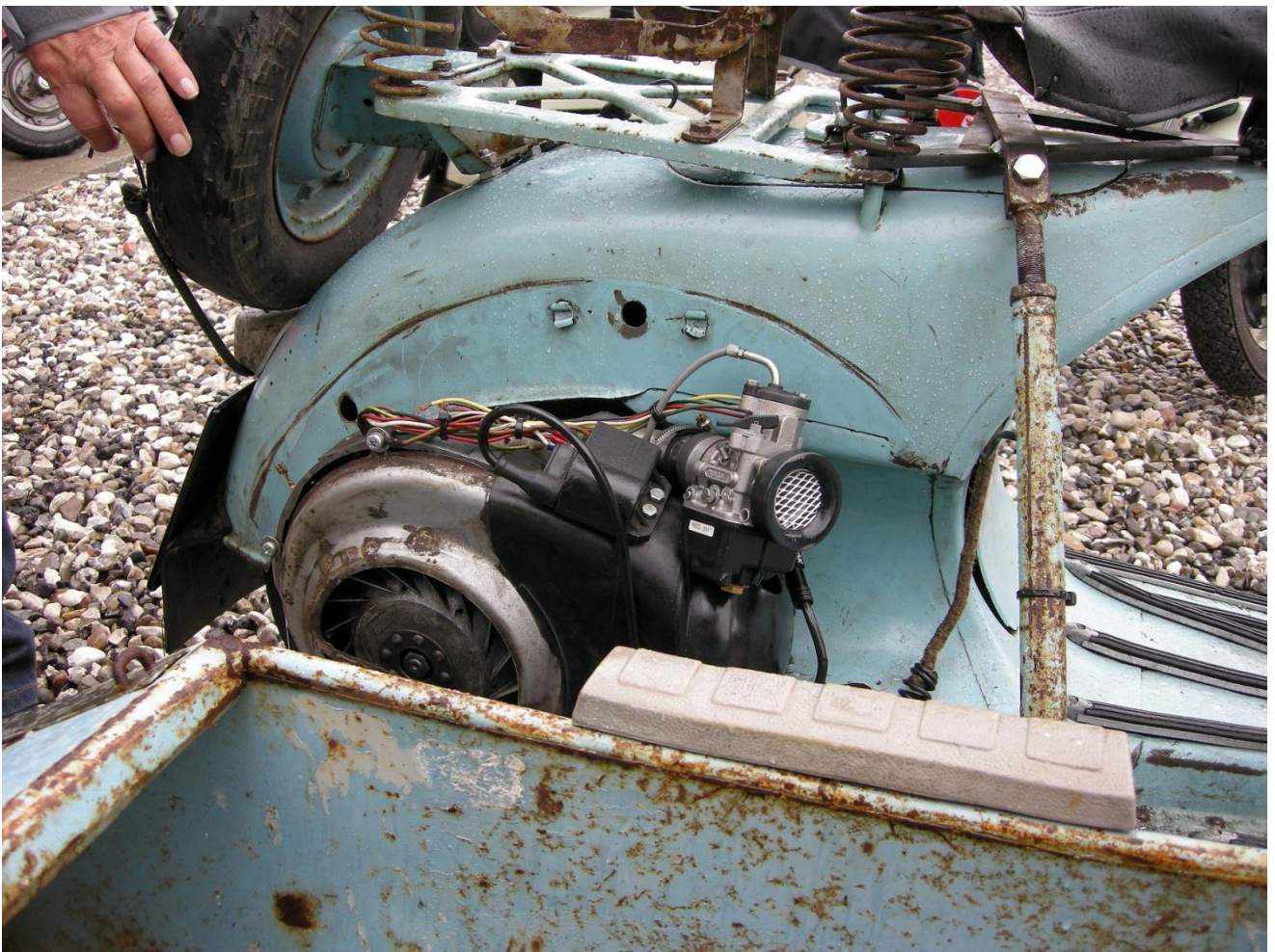
PX motor monteret på 53'eren med 32 mm karburator, en "ulv i fåreklæder".
