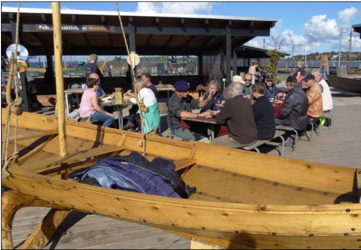
Jørns foto af Knarr båden viser det klinkbyggede håndværk
